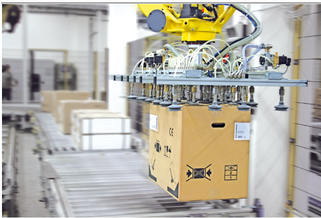
Ventose a soffiutto FSGA per la movimentazione di cartoni
